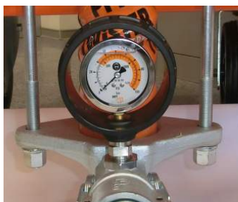
Рис. 44: Манометр давления раствора
