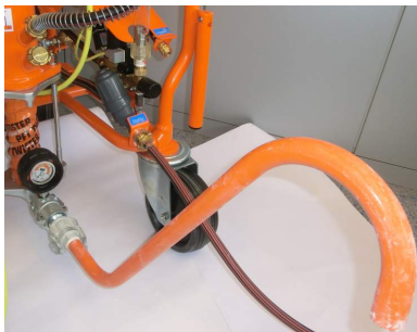
Рис. 50: Труба для контроля консистенции раствора
